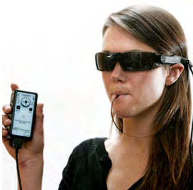
首先在眼镜的镜片里安装微型数码相机，利用相机拍摄外部物体散射的光的信息，然后用“**Wicab BrainPort**”收集照相机拍摄到的信息并传输电极上，电极安放在到舌头两侧，呈“棒棒糖”状排列。这种装置是专门为帮助盲人和视力低下的人设计的，可以让盲人和视力低下的人用“舌头”看见眼前的景象。
