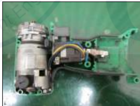
驱动电机与控制开关连接结构
