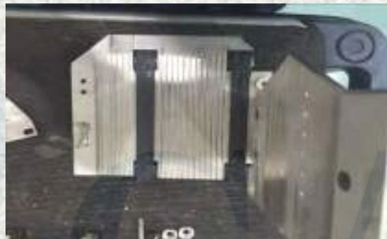
改进后齿形带吸风总成
