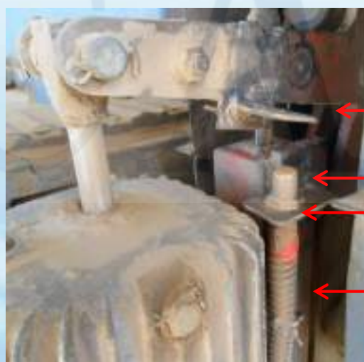
图8 感应式信号开关改造后现场图
