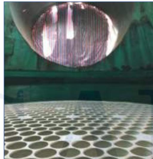
通过气流的增速、汇流、分离、捕捉，最终达到出口烟尘低于 $5\text{mg}/\text{Nm}^3$ 。
