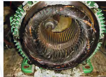
定子绕组损坏
