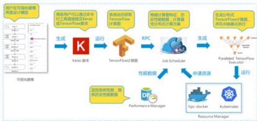
TensorFlow App 自动化分布式执行流程
