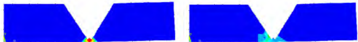
热 - 结构直接耦合分析模拟焊接过程温度分布、应力分布及残余应力分布
