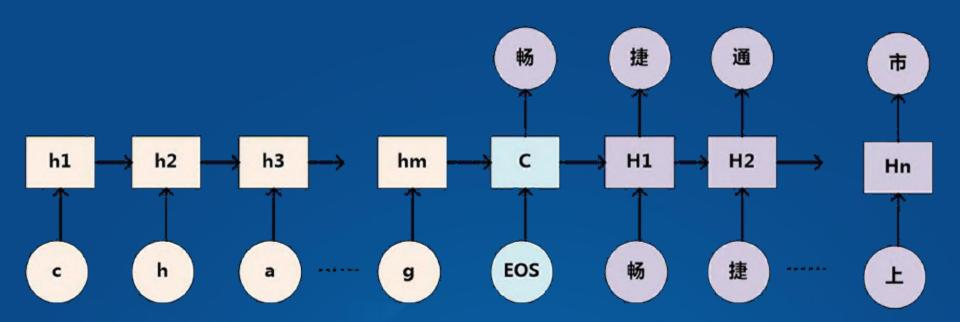
Encoder-Decoder音字转换系统
