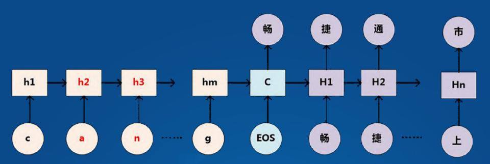
Encoder-Decoder音字纠错模型
