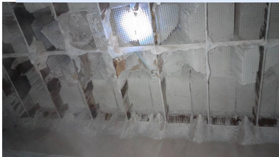
催化剂磨损和塌陷图
